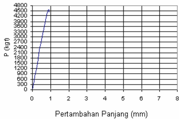
Gambar 8. Diagram Gaya Sebagai Fungsi Pertambahan Panjang Spesimen Baja AISI 1045 Setelah Proses Hardening
