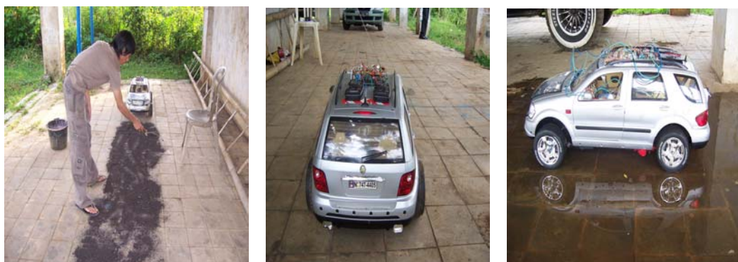
Gambar 1. Pengujian Kendaraan Model Pada Lintasan Pasir , Kering, dan Basah
