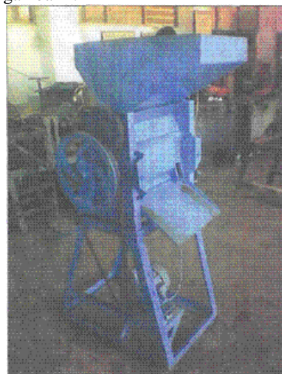
Gambar 1. Mesin Pengupas Biji Kopi
