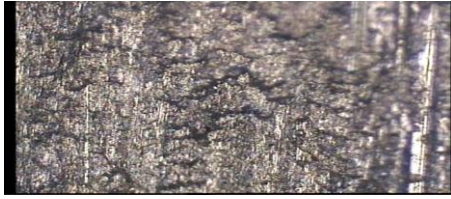
Gambar 15. AC-43100(AlSi10Mg(b)+15%SiC* Sesudah di korosi kering suhu kamar (100°C)
