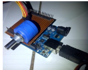
Gambar 13. Potensio Linier Sebagai Driver
