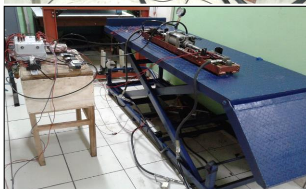
Gambar 5. Sistem hidrolik dan pneumatic dengan Air to hydraulic pressure booster (intensifier) penggerak lifting table
