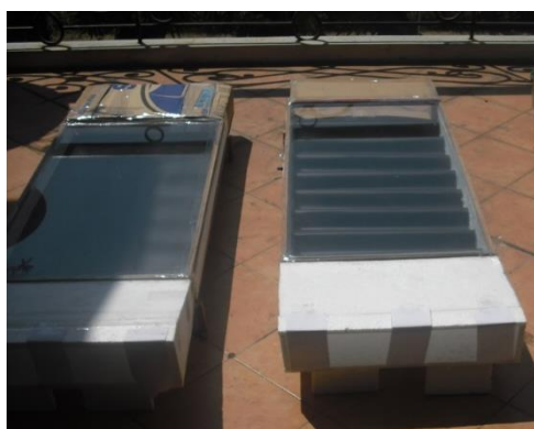
Gambar 5. Kolektor plat datar dan gelombang yang digunakan dalam percobaan.
