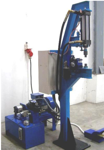
Gambar 9. Hasil jadi mesin tekan rivet
