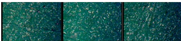
Gambar 10. Foto Mikro Perbesaran 400x Permukaan Kontak dengan Pelumasan (a) Ratio 6.7 (b) Ratio 10.7 (c) Ratio 16.5
