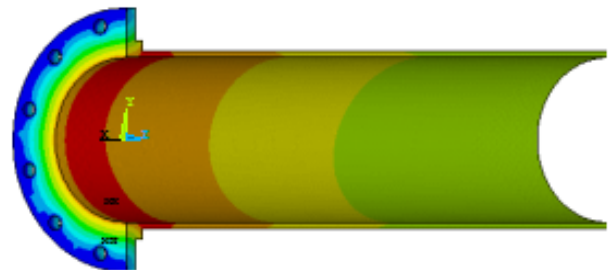
Gambar 8. Displacement untuk Flens pada Pipa
