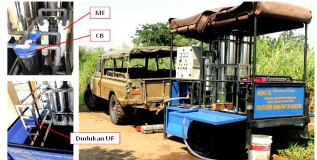
Gambar 7. MSWT-01 Fisikal beserta komponen CB, MF dan Dudukan UF
