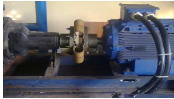
Gambar 1. Pompa sentrifugal dengan pemasangan kopling flens sabuk dalam-dalam
