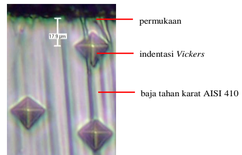
Gambar 6. Perbandingan ukuran indentor terhadap kedalaman benda uji
