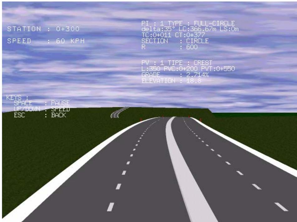
Gambar 14 Visualisasi keselarasan alinyemen yang buruk pada STA 0+300
