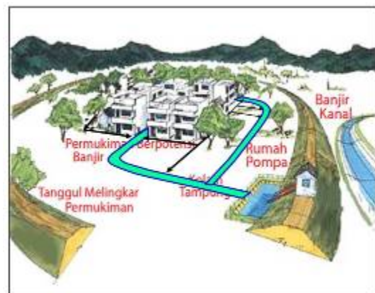
Gambar 34. Ilustrasi Definisi Sistem Polder
