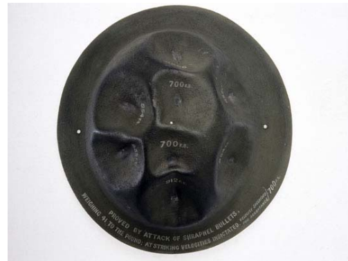
Gambar 2 Helm prajurit Inggris hasil Perang Dunia I yang dibuat dari baja mangan setelah dilakukan uji impak dan menunjukkan stiffness yang baik. (4)
