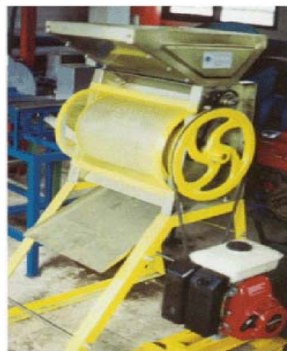
Gambar 2.2. Model Mesin Pengupasan Type Basah Biji Kopi (Sumber: Proyek Teknologi Tepat Guna, Balai Pengembangan Teknologi Tepat Guna, LIPI )
